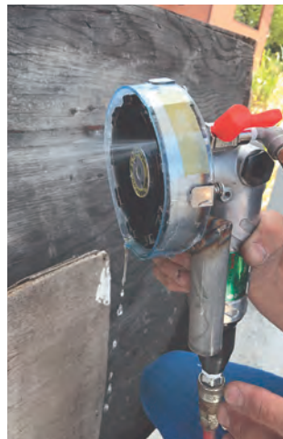
放水しながら剥離物と汚水を同時吸引
